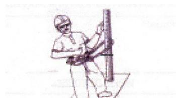
**Passo 2:** Rodar a estrutura, dar duas voltas e conectar o outro extremo ao outro ponto de ancoragem lateral do cinturão. Ajustar a longitude da corda utilizando o elemento regulador.
